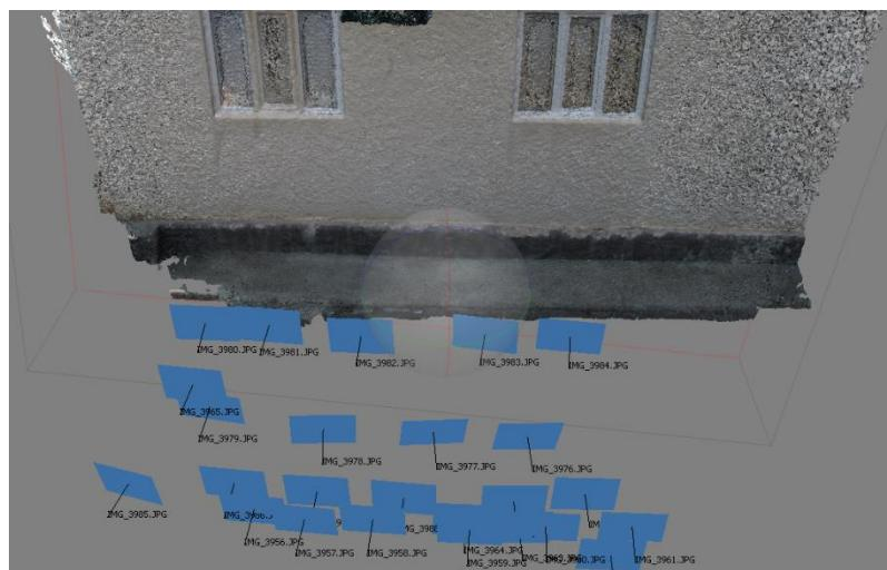
شکل ۱۶: نمایی از شبکه تصویربرداری جهت تولید ابر نقطه مرجع
