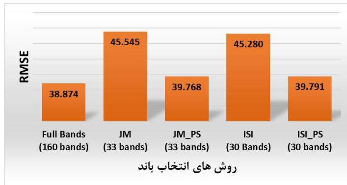
شکل ۱۶: خطای برآورد تصویر ابرطیفی با استفاده از نقشه فراوانی به دست آمده از ماتریس ضرایب با باندهای متفاوت
