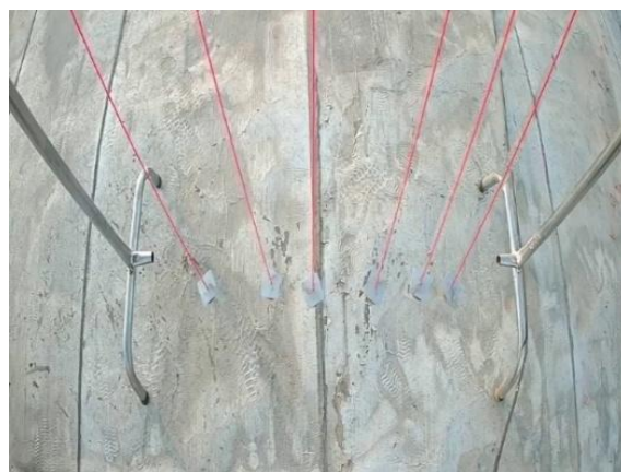
شکل ۱۰: نمونه تصویر اخذ شده از خطوط شاقولی به‌منظور تعیین راستای بردار \vec{Z}_t
