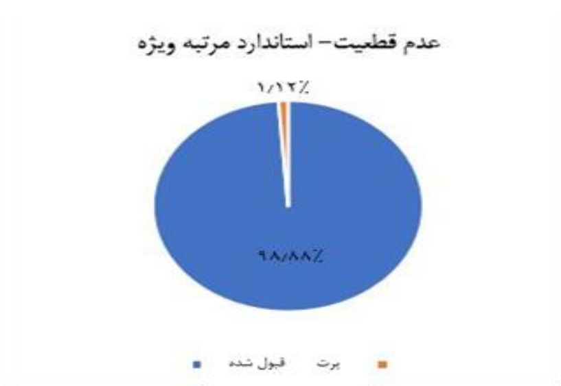
شکل ۱۵: مقادیر قابل قبول اعماق به درصد نسبت به موارد پرت، حاصل از پردازش CUBE
