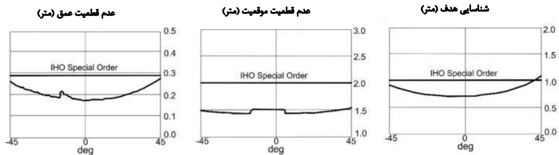
شکل ۷: عدم قطعیت سامانه چندپرتوی در عملیات هیدروگرافی بندر بوشهر
