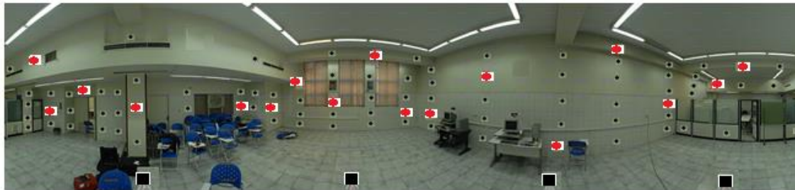
شکل ۶: تصویر اتاق آزمون و محل ایستگاه‌های توتال استیشن. نقاط ضربدر: تارگت‌هایی که با توتال قرائت شده‌اند.
