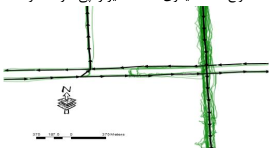
شکل ۱۱: استخراج راه در تقاطع غیر هم‌سطح
