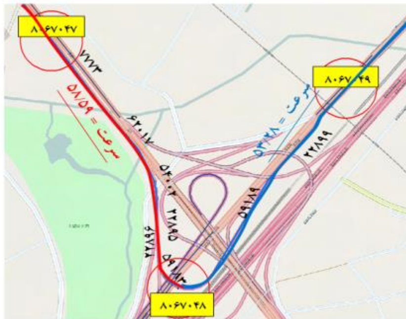
شکل ۶: سرعت متوسط و دنباله یال‌های گراف شبکه راه برای سه نقطه ابتدای خط سیر GPS با شناسه ۲۸
