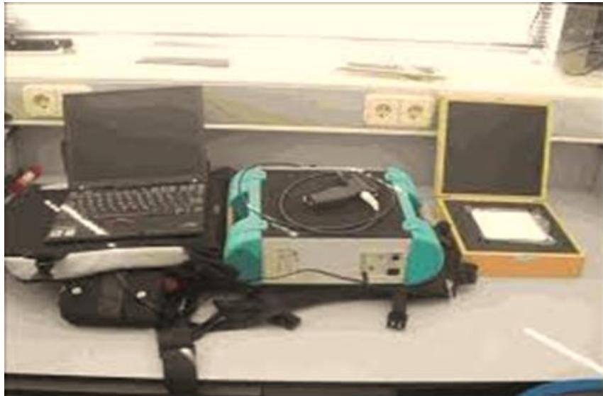
شکل ۲: دستگاه طیف‌سنج میدانی ۳ Fieldspec
