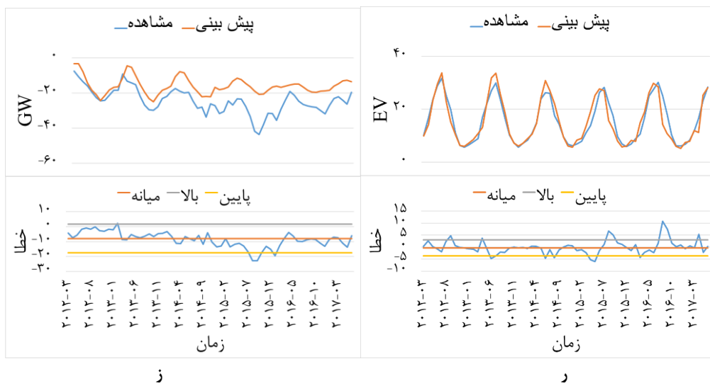
شکل ۷: در هر شکل، بخش بالا، مقادیر واقعی و پیش بینی شده مدل سری LSTM برای هریک از پارامترها در طی سالیان ۲۰۱۲ تا ۲۰۱۷. بخش پایین در هر شکل تفاوت بین داده‌های واقعی و پیش بینی شده را نشان می‌دهد که با استفاده از روش میانه ناهنجاری‌های رخ داده در سری زمانی شناسایی گردیده اند.
