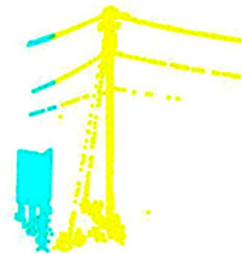
شکل ۲: نمونه‌ای از مجاورت یک عارضه به تیر انتقال برق
