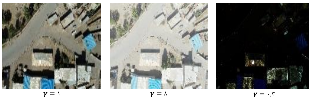
شکل ۲: تغییر میزان روشنایی تصویر اصلی با مقادیر \gamma متفاوت
