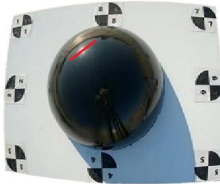
شکل ۶: نمونه‌ای از یک تصویر اخذ شده توسط دوربین ویدئویی از سطح محدب در زمان وجود بازتاب خورشید
