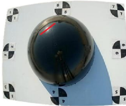
شکل ۶: نمونه‌ای از یک تصویر اخذ شده توسط دوربین ویدئویی از سطح محدب در زمان وجود بازتاب خورشید
