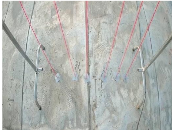
شکل ۱۰: نمونه تصویر اخذ شده از خطوط شاقولی به‌منظور تعیین راستای بردار \vec{Z}_t
