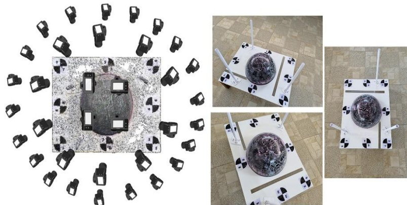
شکل ۳: شبکه ایستگاه‌های عکسبرداری و چند نمونه از تصاویر اخذ شده از سطح محدب با هدف بازسازی سه‌بعدی در نرم‌افزار متاشیپ
