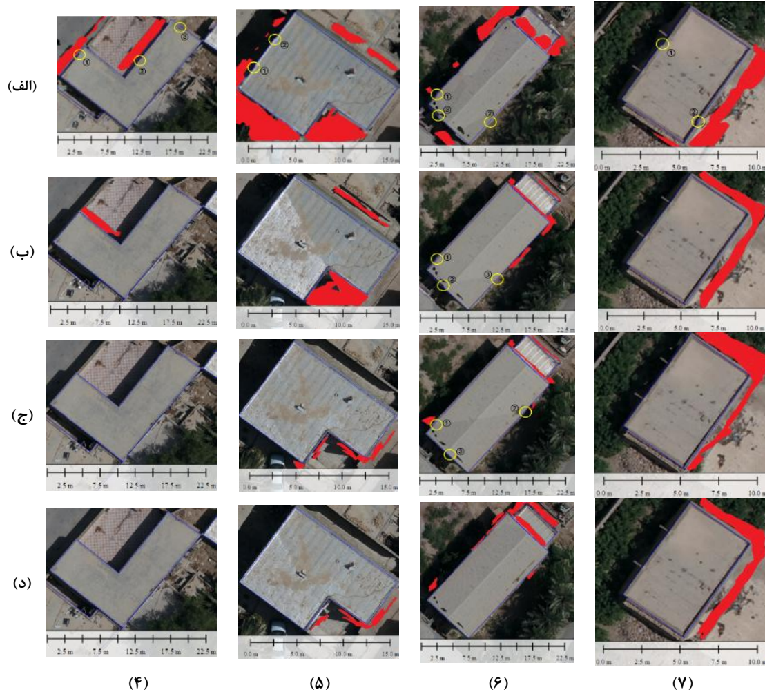
شکل ۱۱: ارزیابی دقت ارتوفتوموزاییک بدست آمده با استفاده از چهار روش (الف) بر مبنای زاویه دید، (ب) بر مبنای فاصله از مرکز تصویربرداری، (ج) بر مبنای فاصله از نادیر و (د) روش پیشنهادی چندمعیاره مبنا در سه ناحیه (۴)، (۵)، (۶) و (۷).
