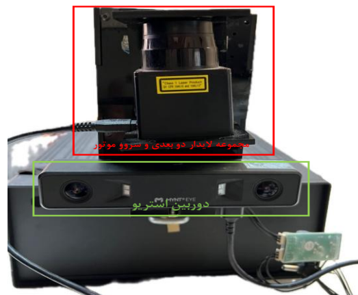
شکل ۲: ساختار سامانه نقشه سازی سیار طراحی شده.
