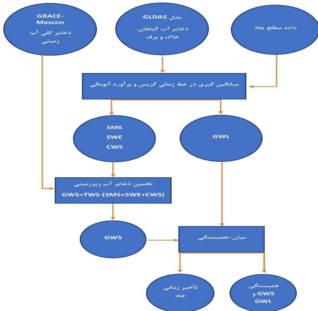
شکل ۳: نمودار روندنمای مراحل طی شده جهت دستیابی به همبستگی بین داده‌های چاه و ذخایر آب زیرزمینی حاصل از مأموریت گریس و مدل GLDAS
