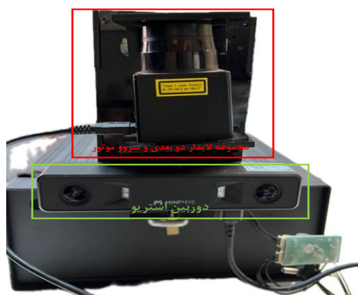
شکل ۲: ساختار سامانه نقشه سازی سیار طراحی شده.
