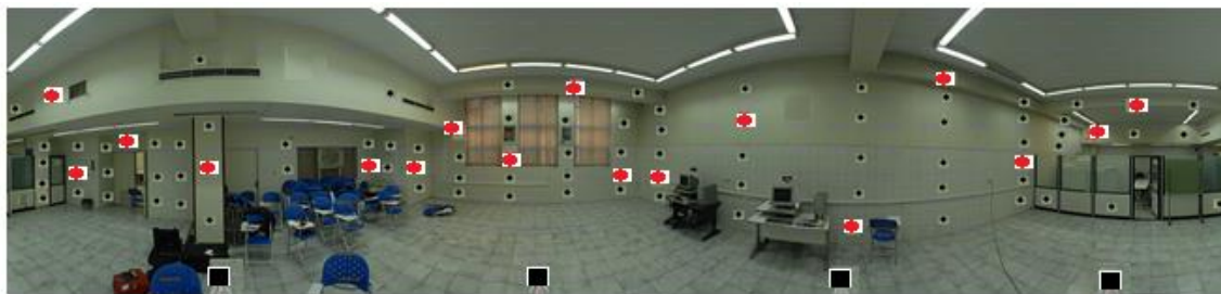
شکل ۶: تصویر اتاق آزمون و محل ایستگاه‌های توتال استیشن. نقاط ضربدر: تارگت‌هایی که با توتال قرائت شده‌اند.
