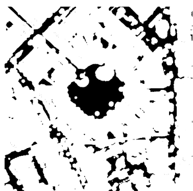
شکل ۱۳: ویژگی بافتی میانگین گابور استخراج شده از DSM
