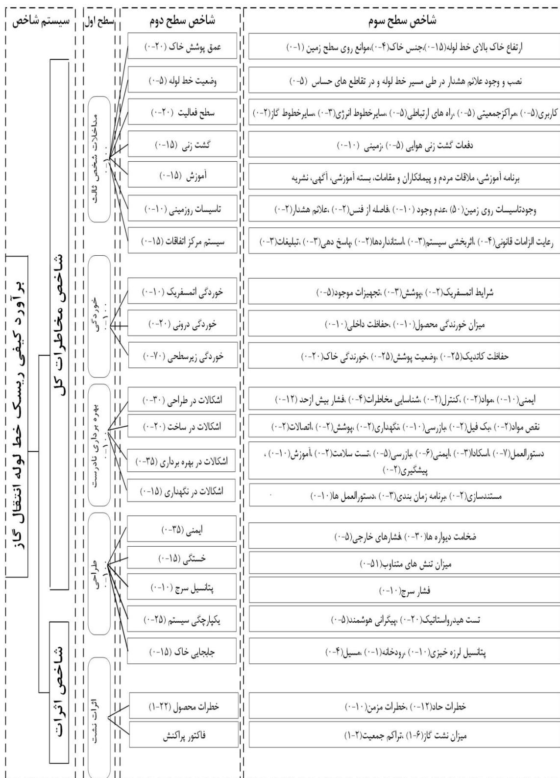
شکل ۱۷: چهارچوب روش سامانه شاخص‌گذاری برآورد ریسک خط لوله
