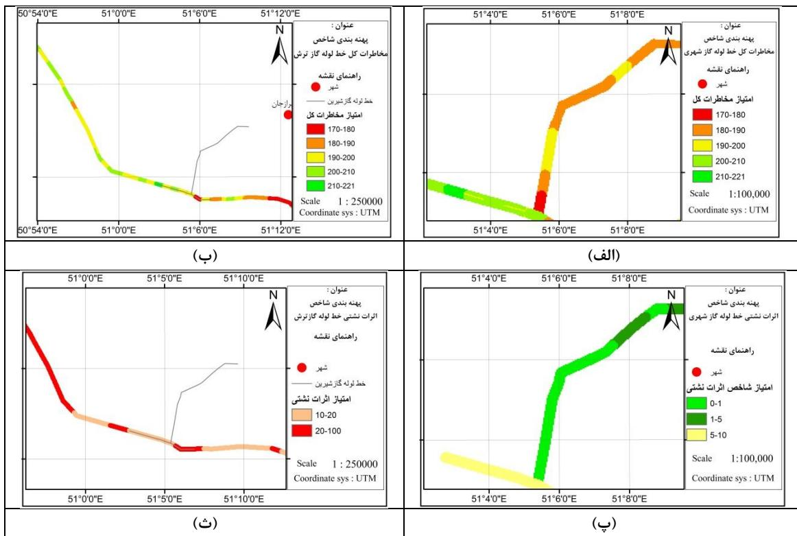
شکل ۷: (الف) نقشه پهنه بندی شاخص مخاطرات کل خط لوله گاز شهری، (ب) نقشه پهنه بندی شاخص مخاطرات کل خط لوله گاز ترش، (ج) نقشه پهنه بندی شاخص اثرات نشتی خط لوله گاز شهری، (د) نقشه پهنه بندی شاخص اثرات نشتی خط لوله گاز ترش
