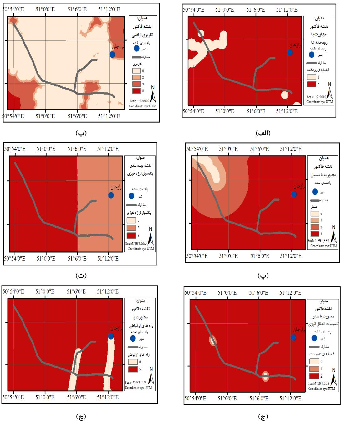
شکل ۵: (الف) نقشه فاکتور مجاورت با رودخانه‌ها، (ب) نقشه فاکتور کاربری اراضی، (پ) نقشه فاکتور مجاورت با مسیل، (ت) نقشه فاکتور پتانسیل لرزه خیزی، (ج) نقشه فاکتور مجاورت با سایر تاسیسات انتقال انرژی، (چ) نقشه فاکتور مجاورت با راه‌های ارتباطی
