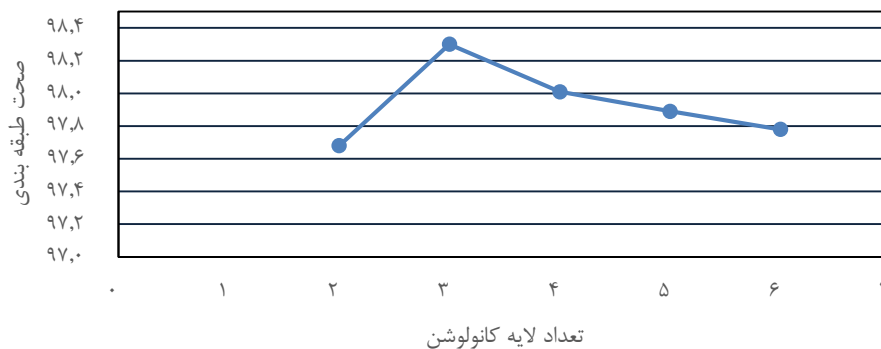
شکل ۴: نتایج آنالیز حساسیت صحت طبقه‌بندی نسبت به تعداد لایه‌های کانولوشن با ثابت نگه داشتن سایر پارامترها
