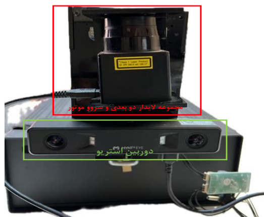
شکل ۲: ساختار سامانه نقشه سازی سیار طراحی شده.
