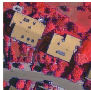
بهبود سوپر پیکسل مربعی به روش DBSCAN
