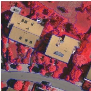
قطعه‌بندی به روش FNEA انتخاب پارامتر مقیاس توسط اپراتور برابر با ۲۰۰
