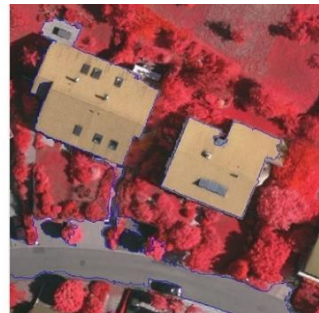
قطعه‌بندی به روش FNEA انتخاب پارامتر مقیاس به صورت خودکار برابر با ۶۲۸
