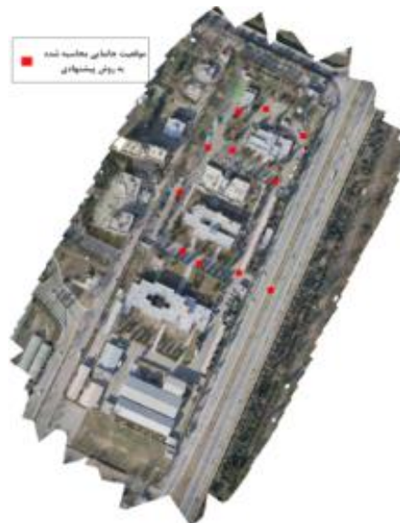
شکل ۱۴: نمایش موقعیت‌های جانمایی بدست آمده برای اسکن‌های زمینی در ابر نقاط هوایی
