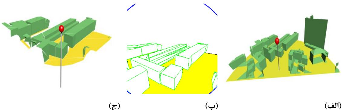
شکل ۸: (الف) چندضلعی‌هایی که روبرو به حسگر هستند و در محدوده فاصله‌ی عملکرد آن قرار گرفته‌اند؛
