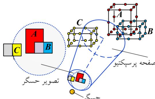
شکل ۵: طبقه بندی چندضلعی های تصویر شده بر روی صفحه پرسپکتیو بر اساس موقعیت آن ها نسبت به دایره پرسپکتیو
