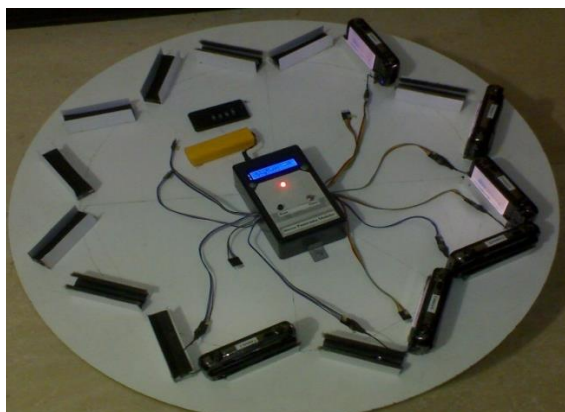
شکل ۱۰: نمایشی از سیستم اسکنر استریوپانوراما ساخته شده
