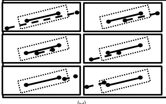
شکل ۲: (الف) در این شکل مستطیل‌های نقطه‌ای، محدوده قابل قبول ( $D \& d \leq T_3$ ) هستند که در فضای تصویر تعریف می‌شوند، (ب) خطوط مقطع و نیز پیوسته به ترتیب خطوط منتقل شده از فضای زمین به فضای تصویر و خطوط متناظر آنها در فضای تصویر می‌باشند. علاوه بر این، دایره‌های سیاه رنگ نقاط ابتدا و انتهای منتقل شده و واقعی می‌باشند.
