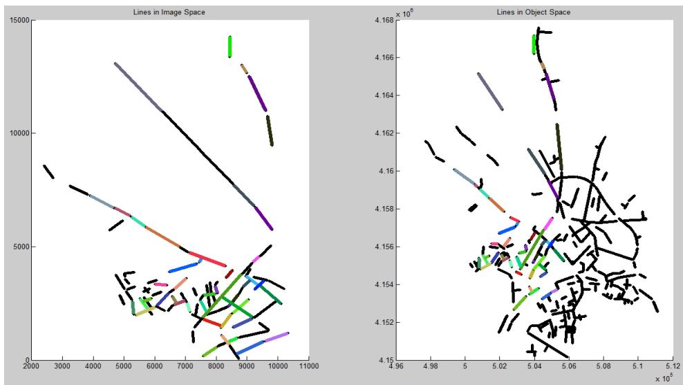
شکل ۵: نمایش خطوط-منتاظر در دو فضای تصویر و زمین با استفاده از روش پیشنهادی **SLIM**
