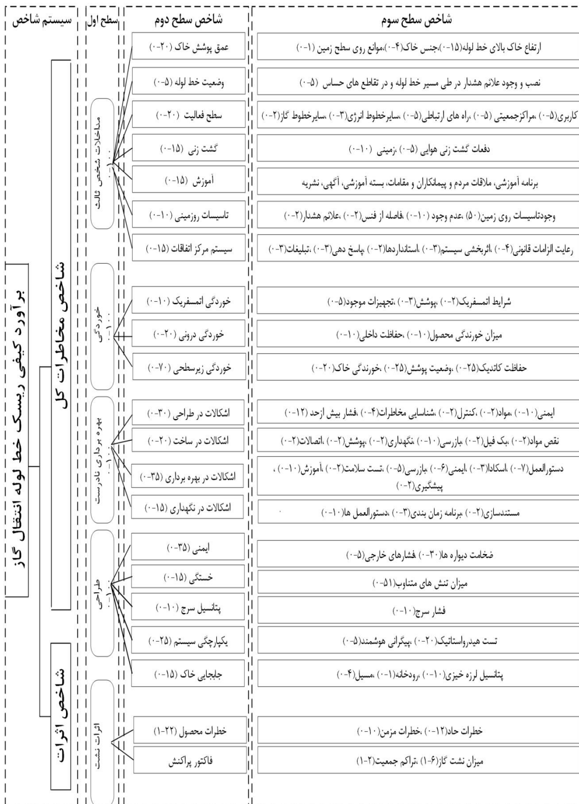
شکل ۱۷: چهارچوب روش سامانه شاخص گذاری برای برآورد ریسک خط لوله
