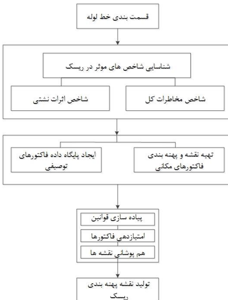
شکل ۱۶: فلوجارت روش سامانه شاخص گذاری
