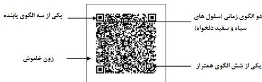
شکل ۴: نمونه‌ای از یک کیوآرکد و ساختار آن [۲۵]
