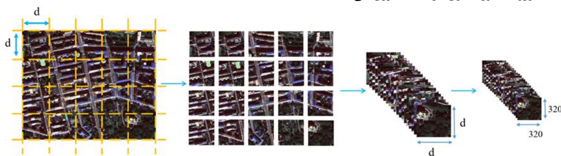
شکل ۲: روند تقسیم تصاویر رقومی که محدوده زیادی را پوشش می‌دهند به تصاویر کوچک‌تر متناسب با ابعاد مورد قبول در شبکه CNN
