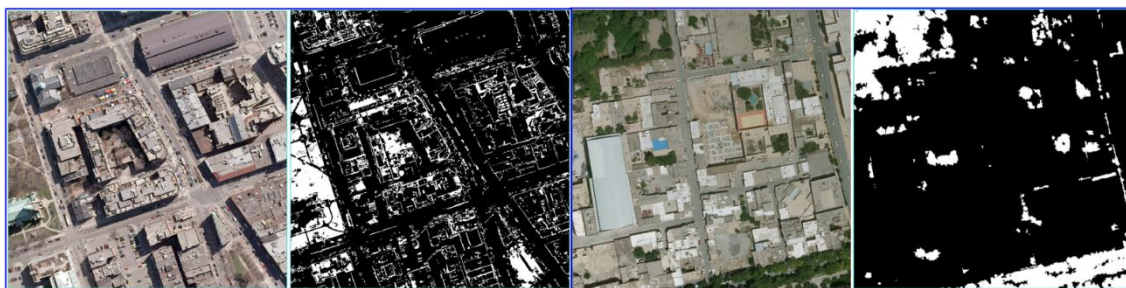
شکل ۶: (الف) داده طیفی مربوط به منطقه اصفهان، (ب) ماسک باینری داده طیفی رده‌بندی شده پوشش گیاهی توسط شاخص پیشنه‌ادی پنجم (بیکسل‌های سفید بیانگر رده پوشش گیاهی در برابر بیکسل‌های سیاه به عنوان اطلاعات پس‌زمینه (غیرپوشش گیاهی))؛ (ج) داده طیفی مربوط به منطقه تورونتو، (د) ماسک باینری داده طیفی رده‌بندی شده پوشش گیاهی توسط شاخص پیشنه‌ادی چهارم.
