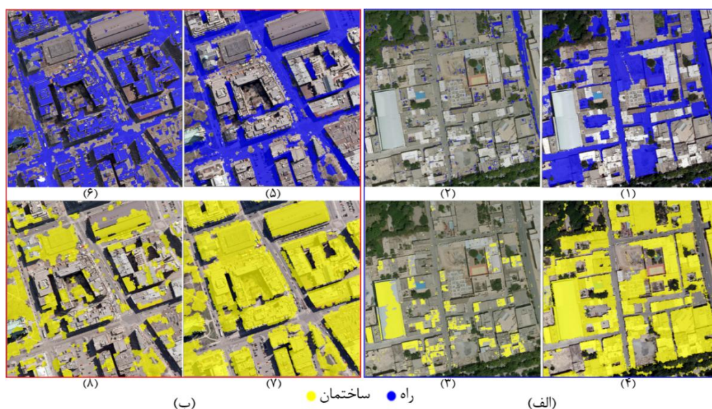
شکل ۱۰: نتایج رده بندی؛ (۱) و (۵): نتایج رده بندی رده راه بر اساس داده لیدار، (۲) و (۶): نتایج رده بندی رده راه بر اساس شاخص های توسعه داده شده، (۳) و (۷): نتایج رده بندی رده ساختمان بر اساس داده لیدار، (۴) و (۸): نتایج رده بندی رده ساختمان بر اساس شاخص های توسعه داده شده بر روی مجموعه نمونه داده تصویری (الف): اصفهان و (ب): تورونتو
