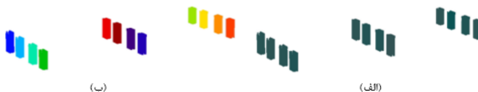
شکل ۲۳: نقاط قطعه پایه پل شماره دو (الف) پیش از قطعه‌بندی و تفکیک و (ب) پس از قطعه‌بندی و تفکیک
