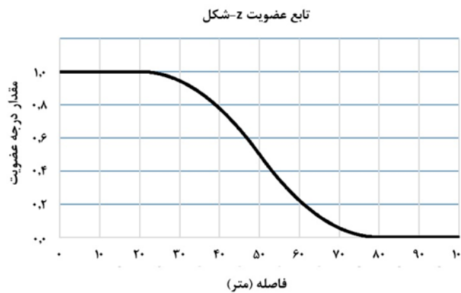
شکل ۳: تبدیل مقادیر فاصله اقلیدسی به بازه [0, 1] از طریق تابع عضویت z شکل
