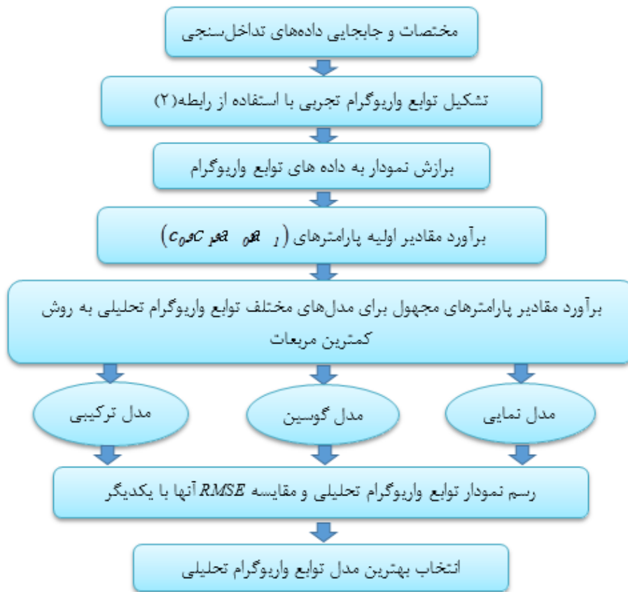
شکل ۲: الگوریتم اجرای روش درونیابی کریجینگ
