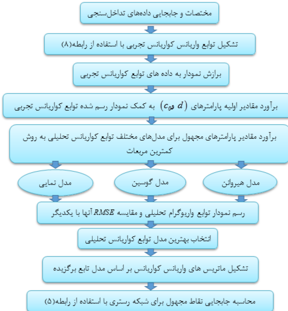
شکل ۴: الگوریتم پیشنهادی روش درون‌یابی کولوکیشن کمترین مربعات
