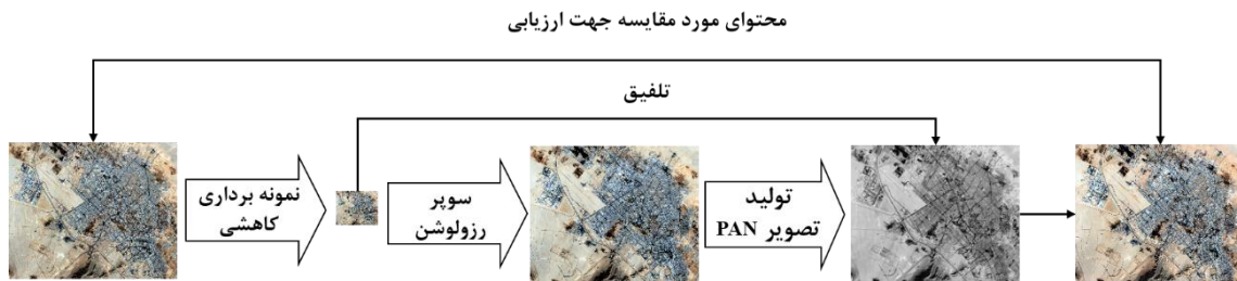
شکل ۴: روند شماتیک تولید محتوا مورد مقایسه جهت ارزیابی میزان حفظ محتوای طیفی در روش پیشنهادی
