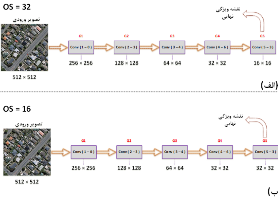
شکل ۲: (الف) خط لوله کلی ساختار اصلی شبکه با ضریب نمونه‌برداری ۳۲، (ب) خط لوله کلی ساختار پیشنهادی با ضریب نمونه‌برداری ۱۶
