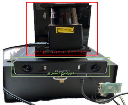
شکل ۲: ساختار سامانه نقشه سازی سیار طراحی شده.
