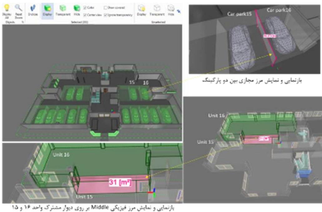
شکل ۱۵: احصای مرزهای مجازی و میانه (Middle) در مدل پیشنهادی (نمایش در BIMvision)
