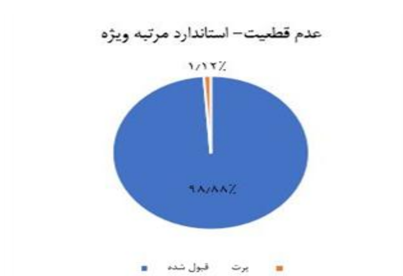
شکل ۱۵: مقادیر قابل قبول اعماق به درصد نسبت به موارد پرت، حاصل از پردازش CUBE
